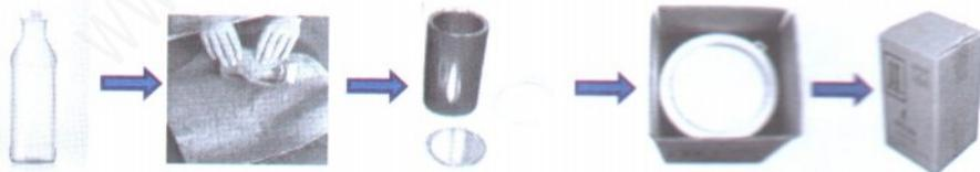
图2-7 玻璃瓶+吸附棉+铁罐+纤维板箱
